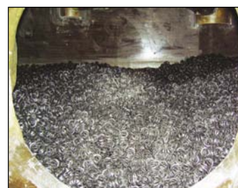
Götaverken Miljö ABs ADIOX-system, fyllkroppar med kol som en extra dioxinspär, integrerat i skrubbersystemet.
